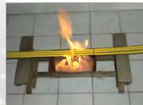
Smoke Density test BS EN 61034
